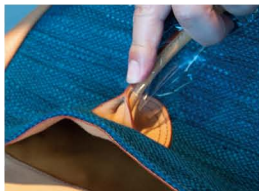
完成したトートには<ソメサドル>の馬具屋らしい細かいこだわりが各所にあった。例えばハンドルを本体に縫い付けた裏側の部分。通常は芯材が見えるのだが、薄い革を1枚かぶせて縫っている。
